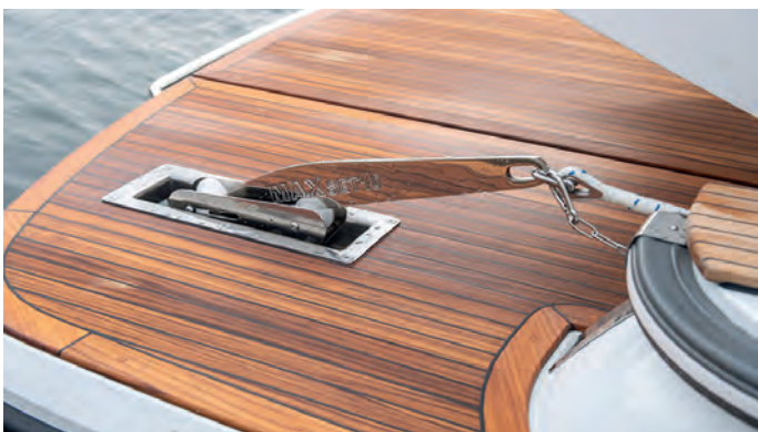
FM33900 후방 전동 윈들러스 (10kg 스테인리스 앵커 포함) (옵션 사양)
