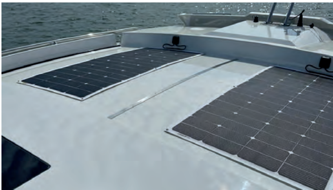
FM331691 루프 장착 100W 태양광 패널 2개 (옵션 사양).
