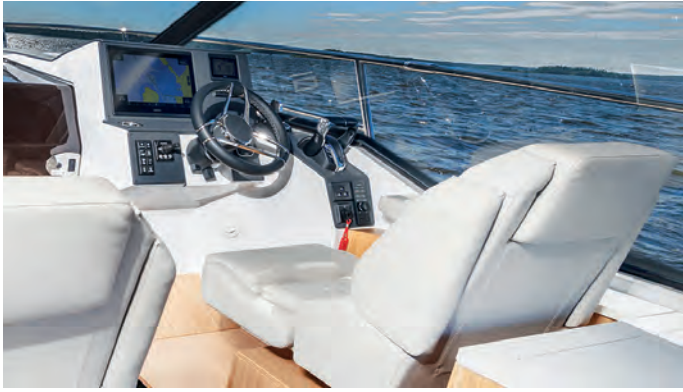
조타석은 12인치 플로터, 보우 스러스터 및 트림 탭이 효율적으로 배치된 설계입니다.
