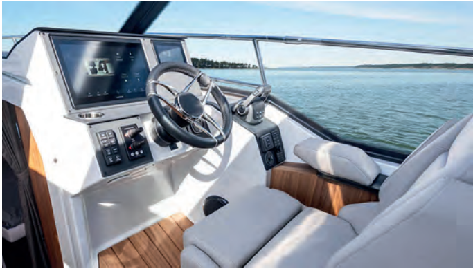
조타석은 12인치 플로터, 트림탭, 보우 스러스터 및 사운드 시스템이 효율적으로 배치된 설계입니다.
